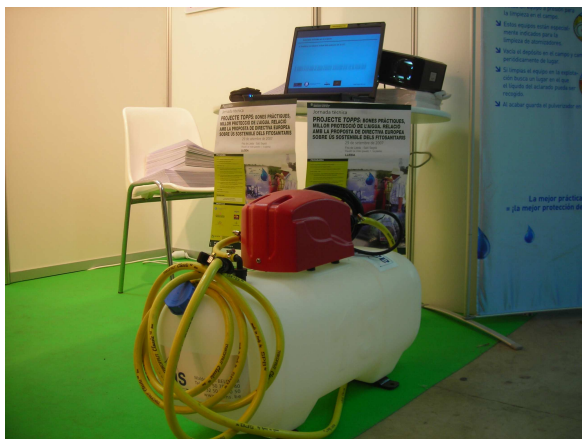
Nádrž na čistú vodu s čistiacou tyčou na čistenie vonkajších povrchov postrekovača (Zdroj: UPC)
